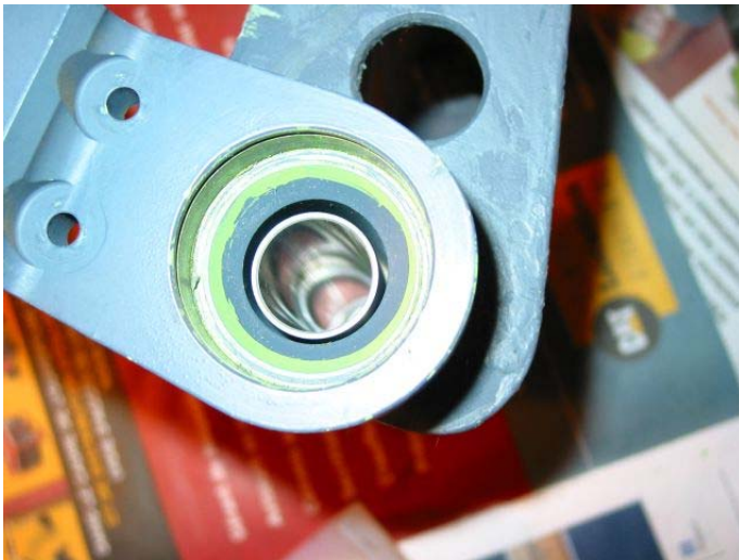
On constate qu'il y a maintenant un jeu entre le tube et la paroi du pédalier...espace qu'il faudra combler.
