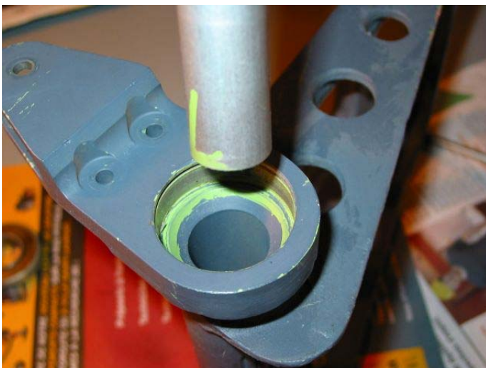
Pour combler le vide entre le tube et la paroi, j'utilise le matériau constituant un récipient de lave glace. Sans en être certain ce matériau ressemble...
