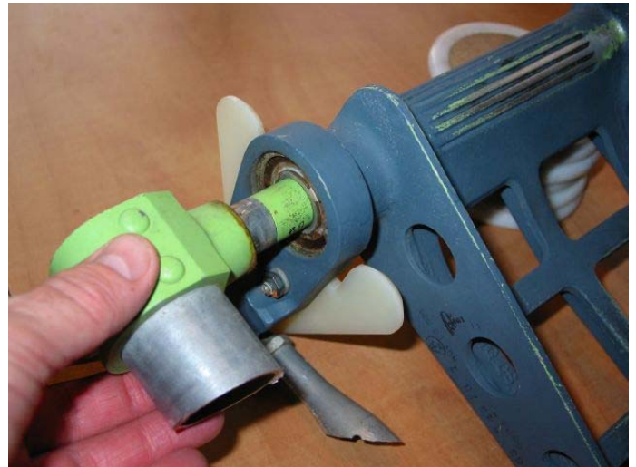
Retirer la tige centrale après avoir déboulonné le tout.
