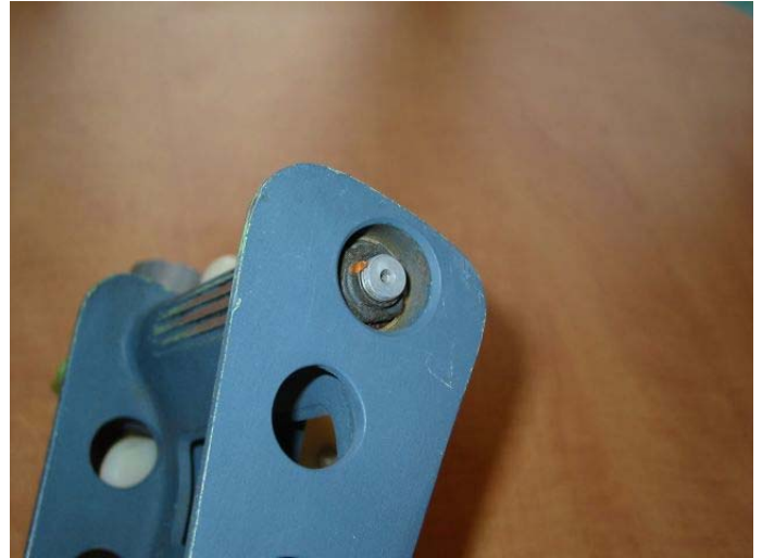
Et voici l'autre côté avec son écrou auto bloquant.
